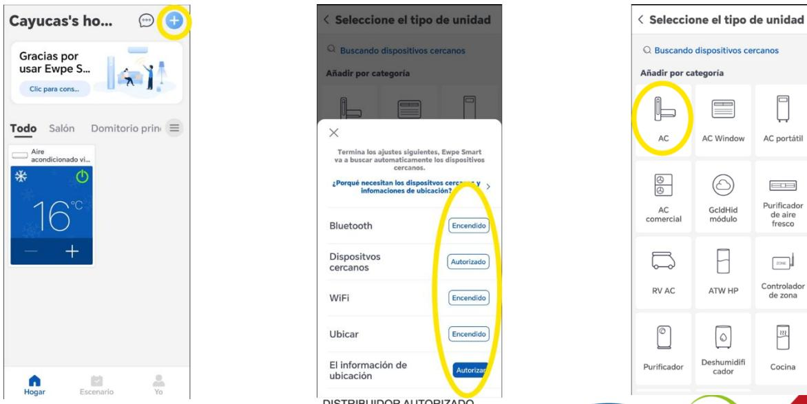
7.- Con el equipo apagado (Durante todo el proceso de vinculación) activa el receptor de señal WIFI (solo dura 2 min activo), para esto debes presionar la tecla MODE + WIFI simultáneamente hasta escuchar un beep en la unidad, en la app seleccionar que completaste la operación y dar en “SIGUIENTE”.
